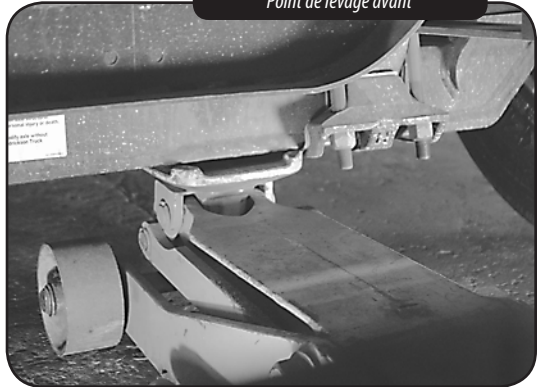
Point de levage avant
